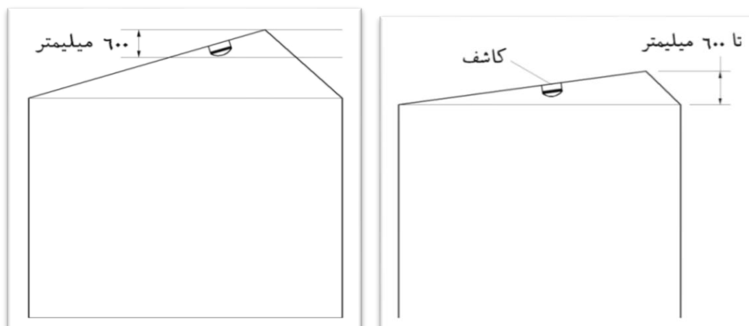
شکل ۲۱- نصب آشکارسازهای دودی در سقف‌های شیب‌دار
